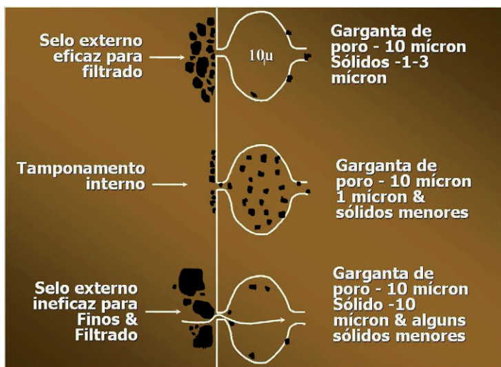
Figura 7 - Danos causados por filtrado do reboco e sólidos da lama.
